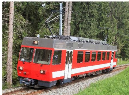
Nachher: umgebautes Fahrzeug der CJ, 1600 Volt
